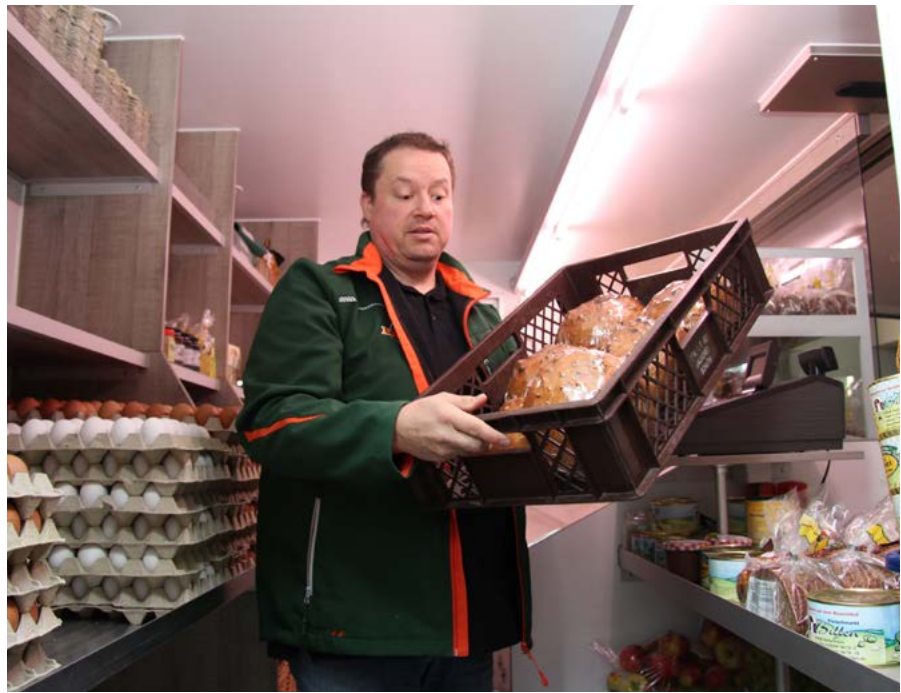
Der Mittelgang im Verkaufsmobil sollte mindestens 70 cm breit sein. Besser sind 75 bis 80 cm, dann lassen sich die Produkte einfach einräumen.
